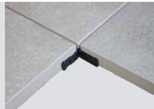
**FUGENKREUZ:** dient zur gleichmäßigen Verlegung von Platten auf festem Untergrund oder als Montagehilfe für die Verlegung in Splitt. Es ist 10 mm hoch, 3 mm stark und ist stapelbar.
