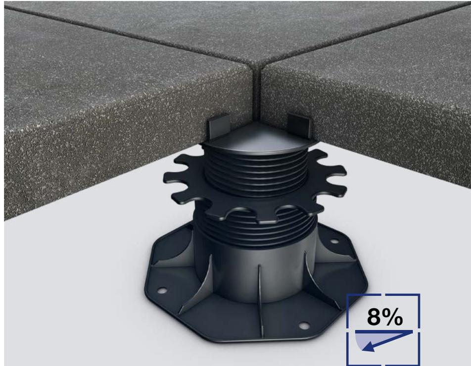
**TERRASSENLAGER MIT FUGENKREUZ:** Für den Höhenausgleich bei der Verlegung mit Steinplatten. Die Fugenbreite beträgt 3 mm und durch den flexiblen Kopf werden Unebenheiten problemlos ausgeglichen.
